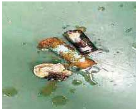
発火原因になった乾電池
