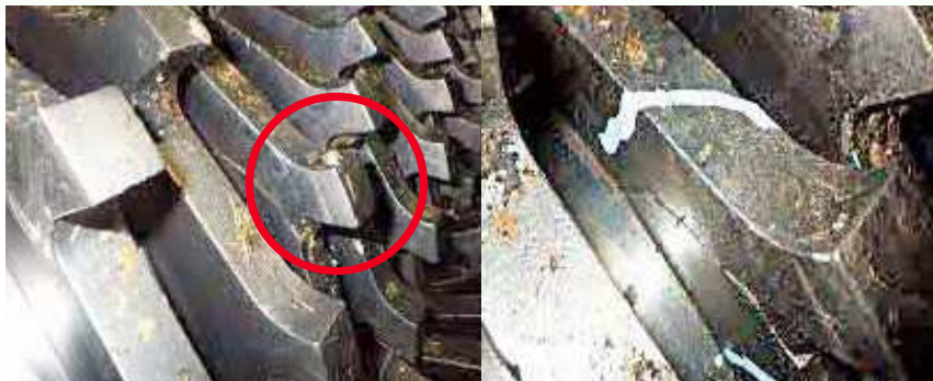
破損した破砕機
