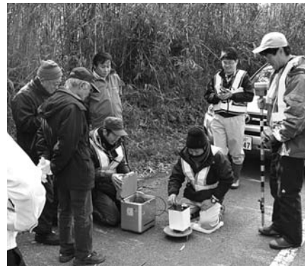
重力調査を行う調査関係者
