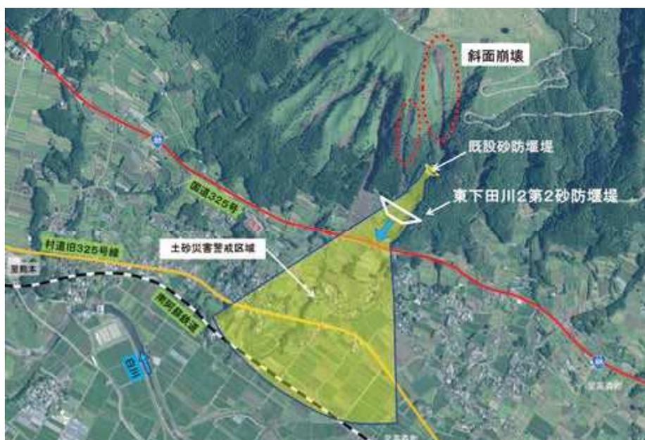
東下田川流域は、阿蘇山中央火口丘群を構成する夜峰山の南に位置し、白川に注ぐ溪流となっています。新設した砂防堰堤の標高は400m～500mで背後の夜峰山頂部との標高差は約400mです。既設砂防堰堤と東下田川2第2砂防堰堤の2基をもって、約33,000m<sup>3</sup>の不安定な土砂を捕捉する計画になっています。
