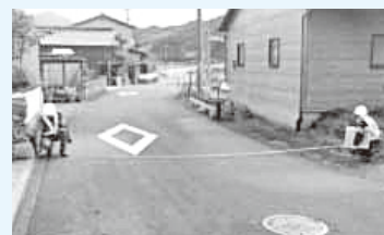
道路幅員計測状況
