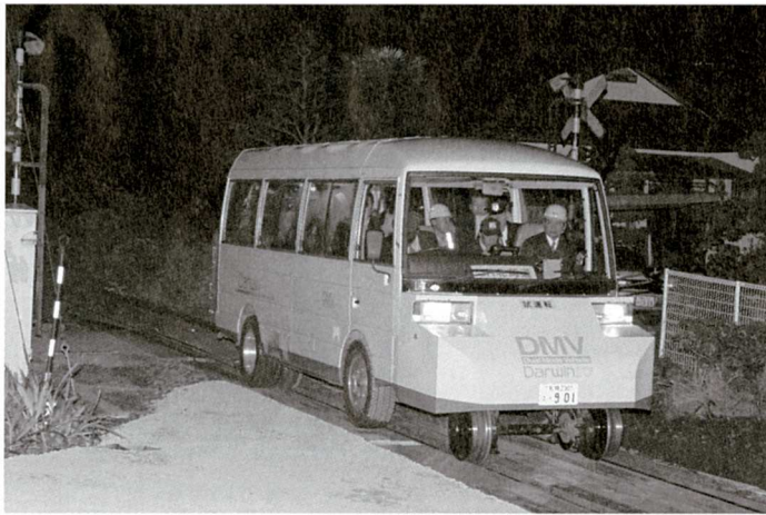
線路から道路へモードチェンジを行う様子
