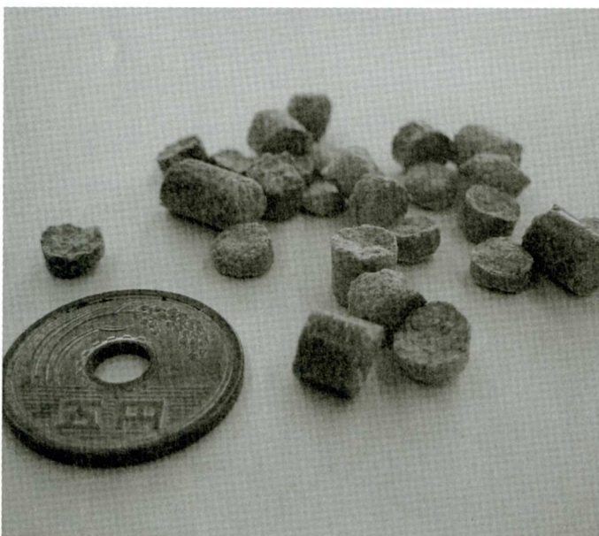
木質ペレット 〈製材加工時に発生する端材やおがくずなどを高圧で固めたもの〉
