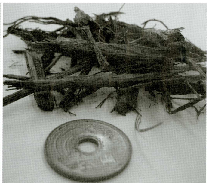
木材チップ 〈木材をチップパー(切削破碎機)に投入して作られたもの〉
