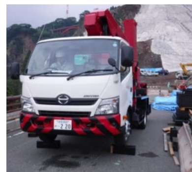
車両の段差落下試験の実施状況
